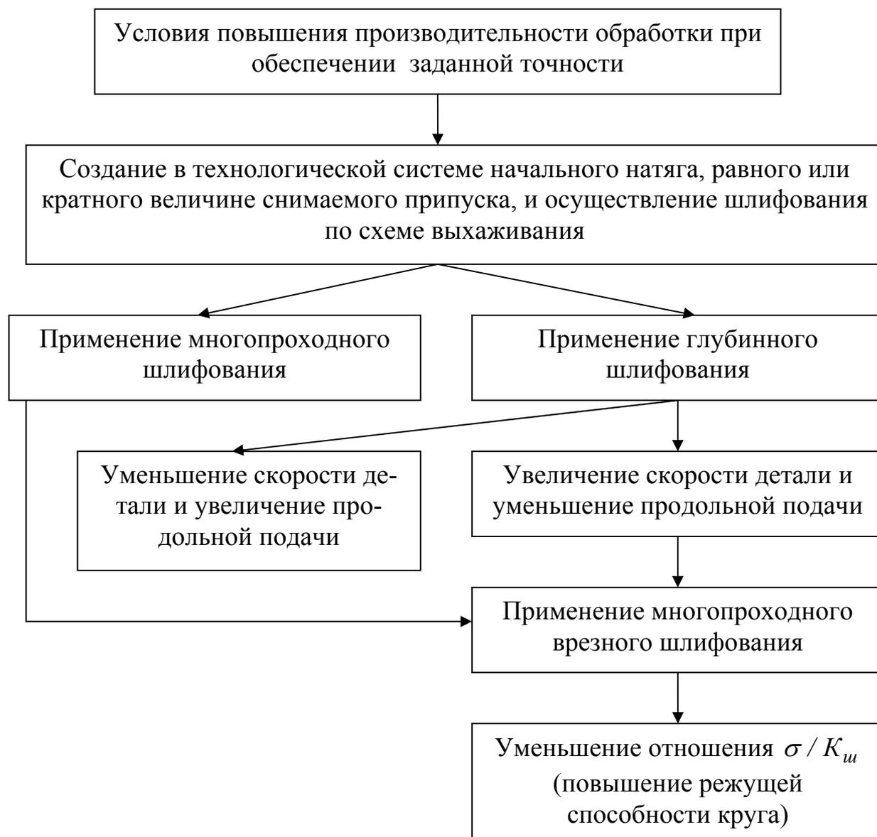
Рис. 2. Структурная схема условий повышения производительности обработки при обеспечении заданной точности обрабатываемой поверхности при круглом наружном шлифовании
