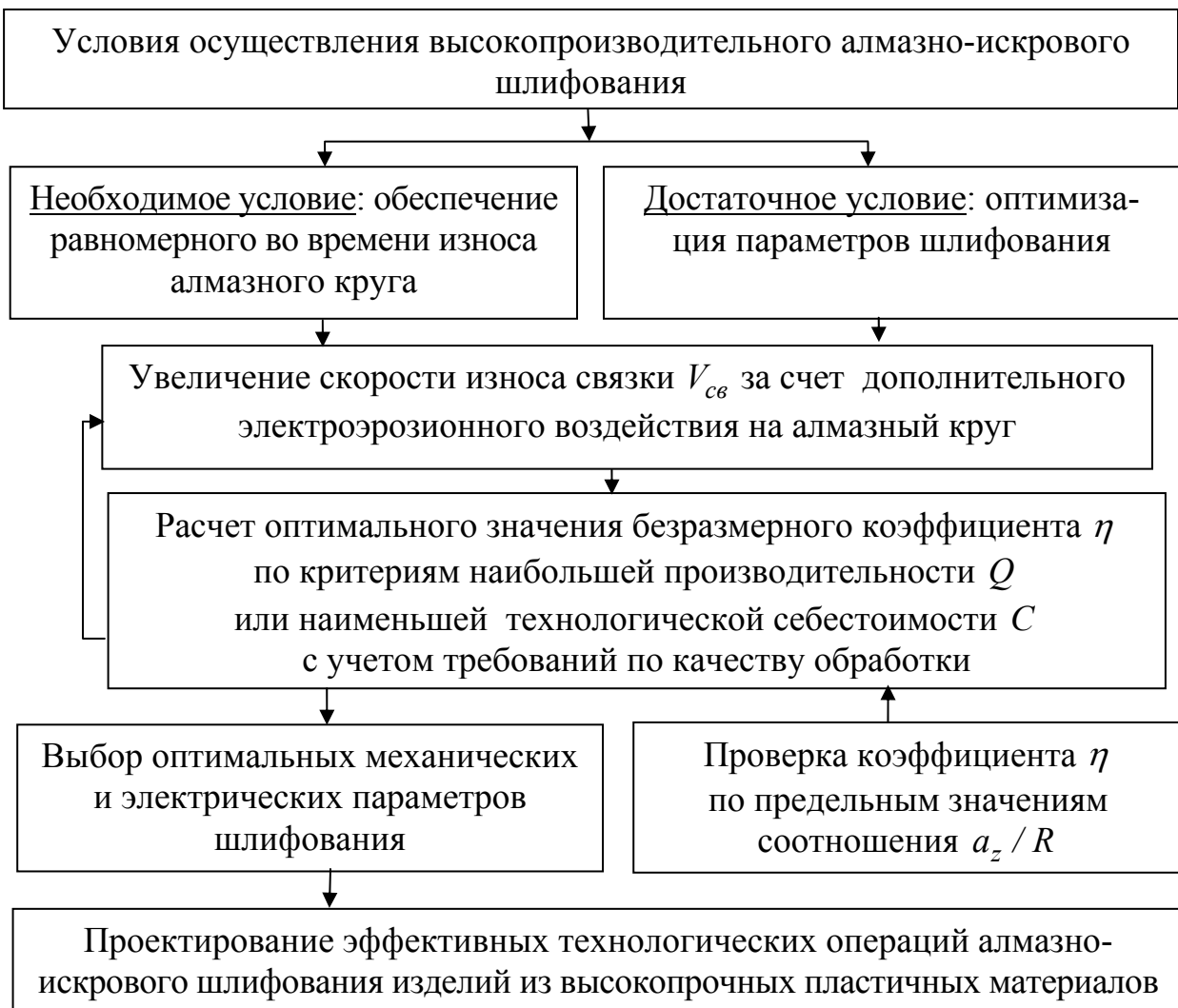
Рис. 7. Структурная схема выбора оптимальных условий алмазно-искрового шлифования.
