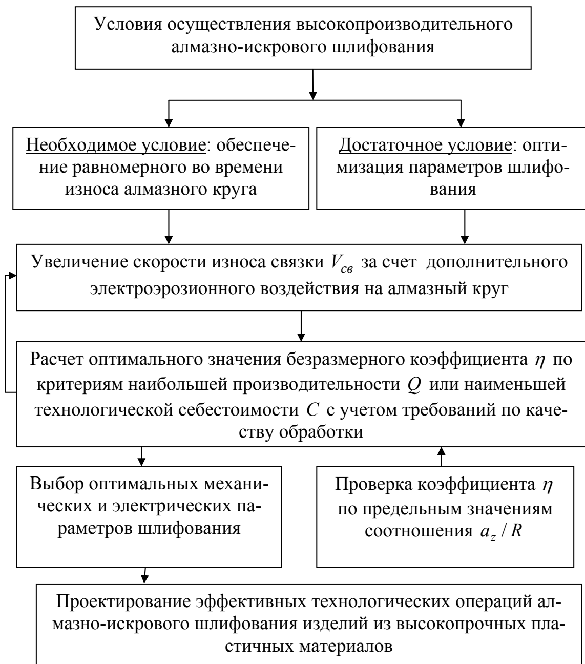
Рис. 3. Структурная схема выбора оптимальных условий алмазно-искрового шлифования.
