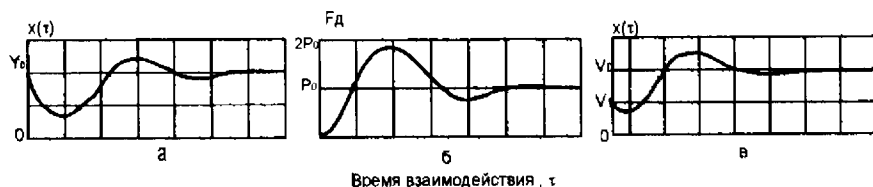
Рис. 6.20. Изменение скорости движения инструмента \dot{x}(\tau) и динамической силы F_d от времени \tau при v_1 = v_0 (а, б) и v_1 < v_0 (в).
