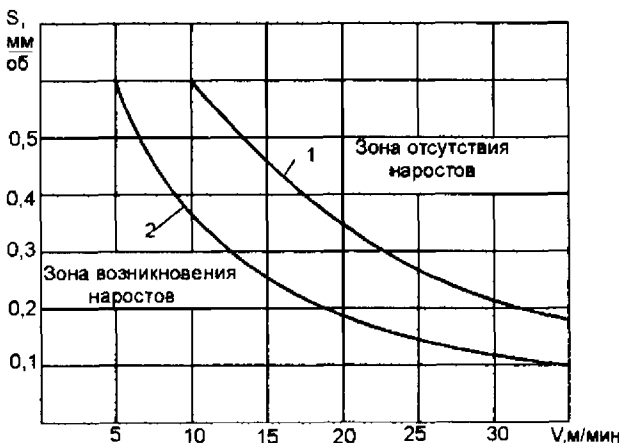
Рис. 7.19. Границы зон наростообразования: 1 для стали 45, 2 для стали OX12HD.
