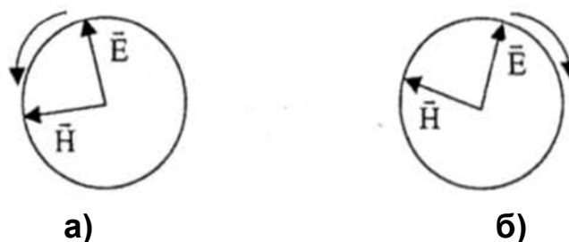
Рис. 7.11. Обертання векторів \vec{E} і \vec{H} вліво (а) і вправо (б)
