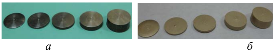
Рис. 2. Образцы из латуни ЛС59.1 в форме диска диаметром 20 мм и толщиной 0,5; 1; 2; 4 и 8 мм до обработки (а) и после обработки (б)
