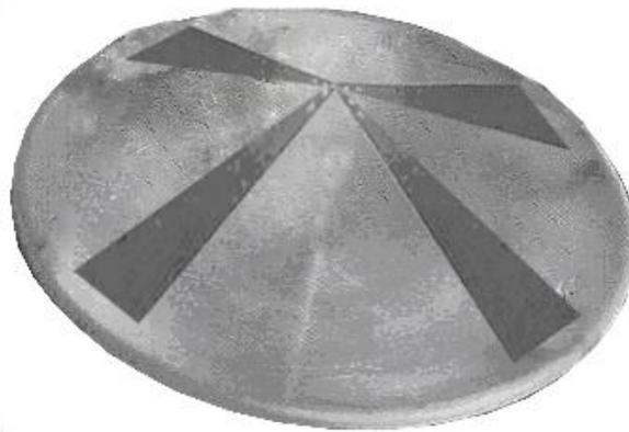
Рисунок 4.4 - Конструкция короткоимпульсной зеркальной антенны
