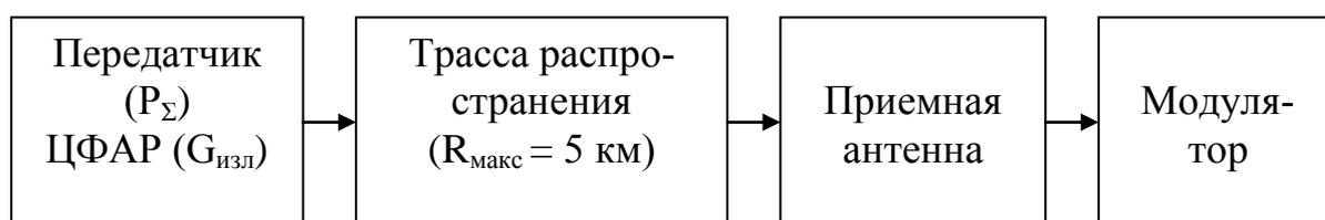
Рисунок 3.21– Структурная схема радиоканала
