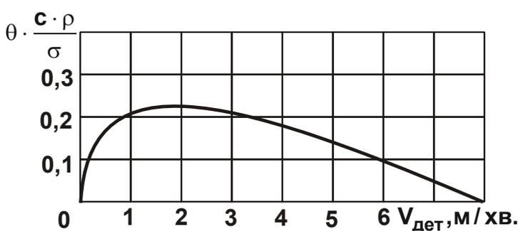
Рис. 5.18. Зміна функції  $\theta \cdot c \cdot \rho / \sigma$  від швидкості деталі  $V_{дет}$
