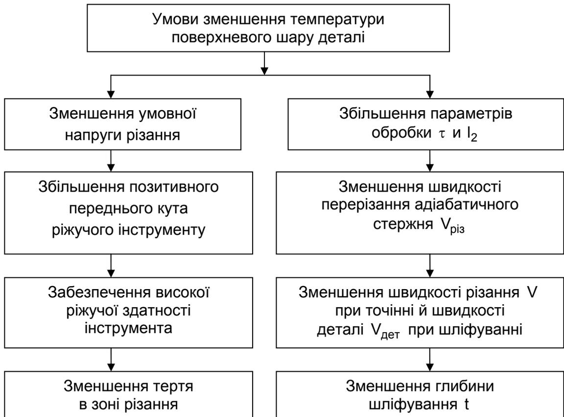
**Рис. 2.18. Структурна схема умов зменшення температури поверхневого шару деталі при її механічній обробці**
