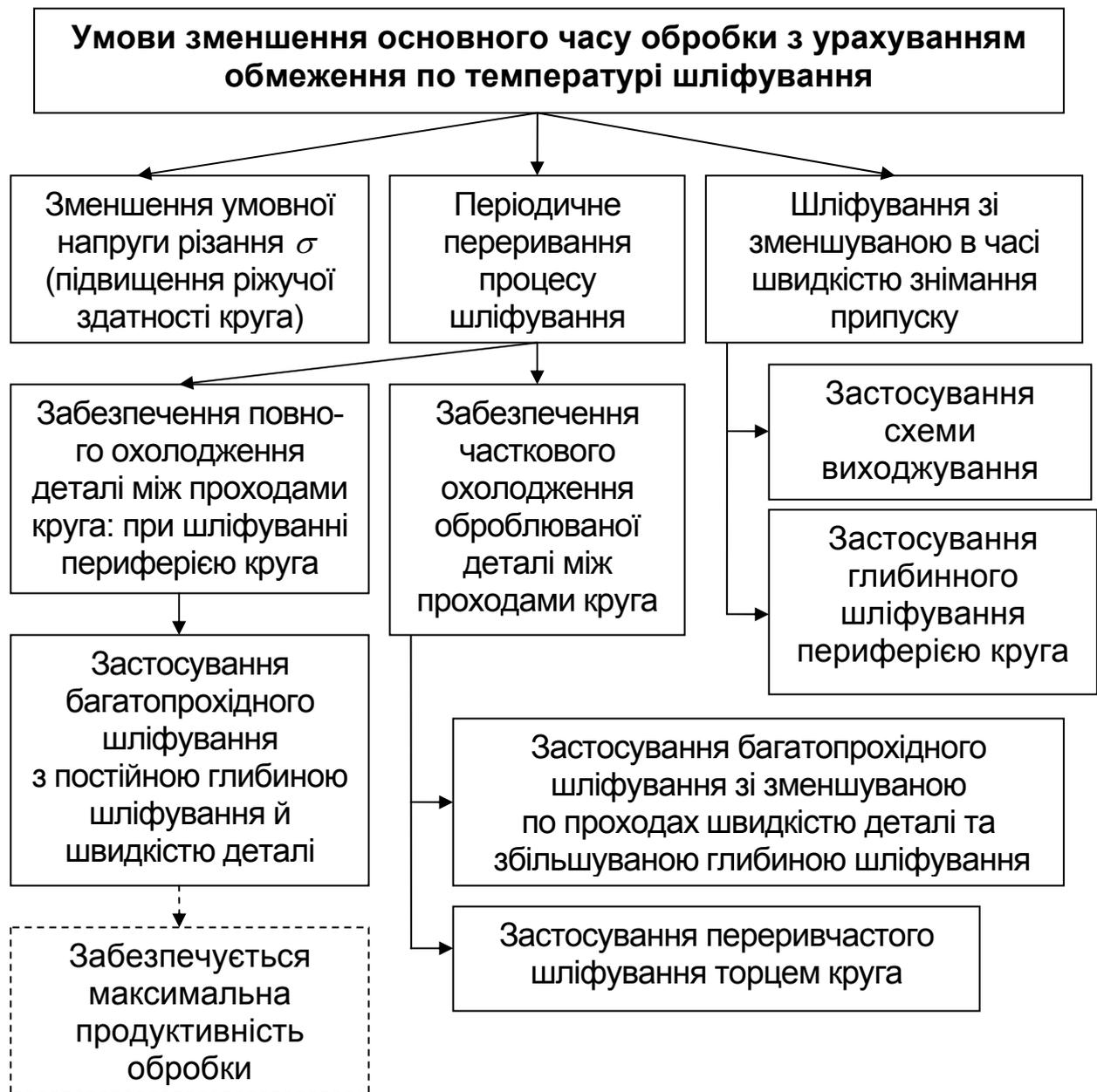
**Рис. 5.20. Структурна схема умов зменшення основного час обробки з урахуванням обмеження по температурі шліфування**
